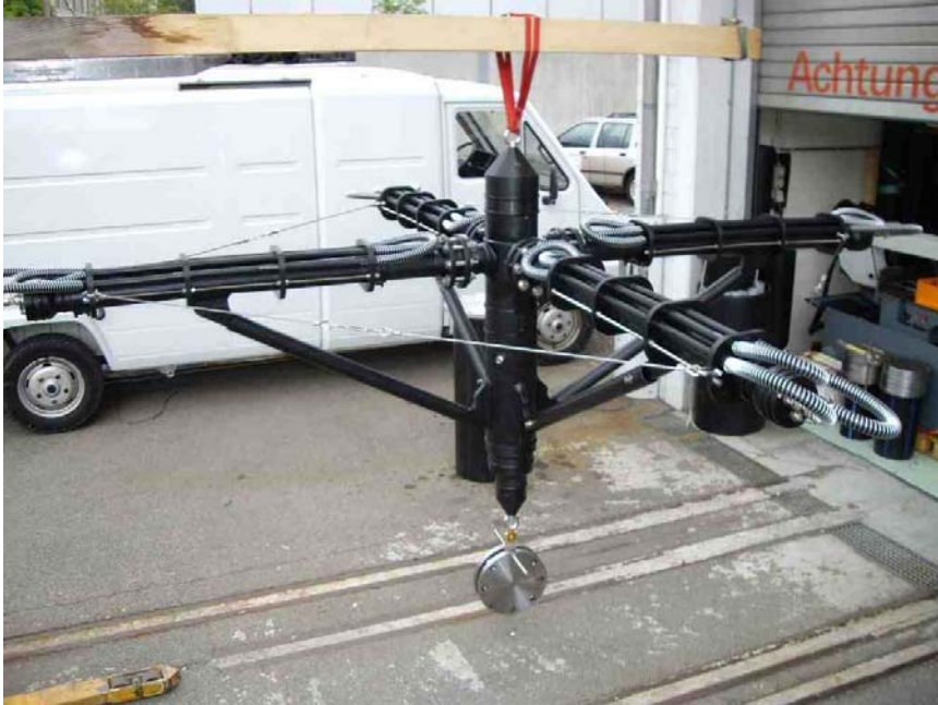
Figur A1 - Montage des Diffusorschlauches an der Diffusoreinheit Tanytarsus. Tiefe = 12.5 m. Eigenschaften des Schlauches: 40 m Länge, 3000 Poren/m. Durchmesser des Kreuzes: ~5 m. http://www.hans-grassl.com .
