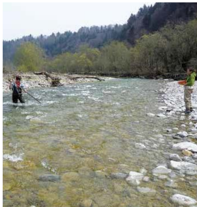
Fig. 2 Misurazione della larghezza e della profondità di un tratto di fiume nell'ambito di un controllo dei risultati. Foto: Armin Peter
