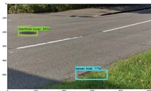
Abbildung 1: Detektion von Einlaufschächten (türkis) und Schachtdeckeln (grün) innerhalb eines Strassenbildes.
