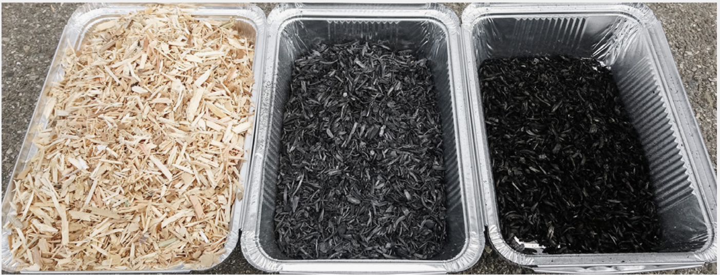
Fig. 2 Altholz, Holzkohle aus pyrolysiertem Altholz (900 °C) und Aktivkohle aus Altholz (von links nach rechts) im ungefähren Verhältnis des Masseverlusts während der Produktion. Hochtemperatur-Holzkohle ist anthrazitfarben, während die aktivierte Kohle schwarz ist.
