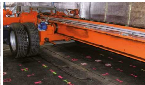
Abbildung 2: Links, stationärer Rundlauf der ETH Zürich am Standort Dübendorf; rechts, Grossversuchsanlage der Halle Fosse in Lausanne.
