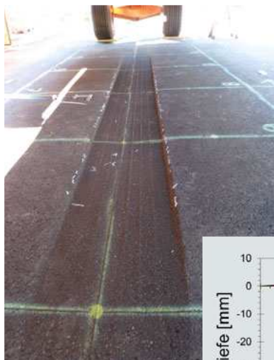
Abbildung 5: Spurrinne nach einer kanalisiertem MLS10-Belastung, verursachter Belagsschaden, mit Diagramm der schematischen Spurrinntentiefe eines T2-Belags in Abhängigkeit zu der Anzahl Überrollungen.
