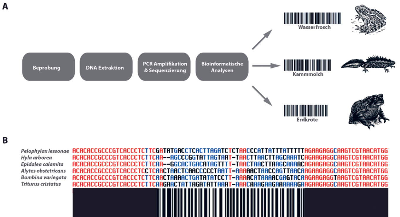
Abb. 1. Ablauf einer eDNA-Analyse zu einem Artengruppen-Nachweis mittels Next-GenerationSequencing. (A) Nach der Probenahme von eDNA in einem Gewässer wird die gesamte eDNA in der Wasserprobe gewonnen (Extraktion), die Barcoding-Region mittels PCR vervielfältigt (Amplifikation) und dann mittels Next-Generation Sequencing sequenziert. Im Anschluss werden die Daten bioinformatisch ausgewertet und den DNA-Sequenzen die jeweiligen Artnamen (z.B. Amphibienarten) zugewiesen. (B) Aufbau einer Barcoding-Region mit den für die Zielgruppen einheitlichen Enden (hier v.a. rot) und dem sehr vielfältigen Bereich, welcher als Barcode dient (hier v.a. blau und schwarz).
