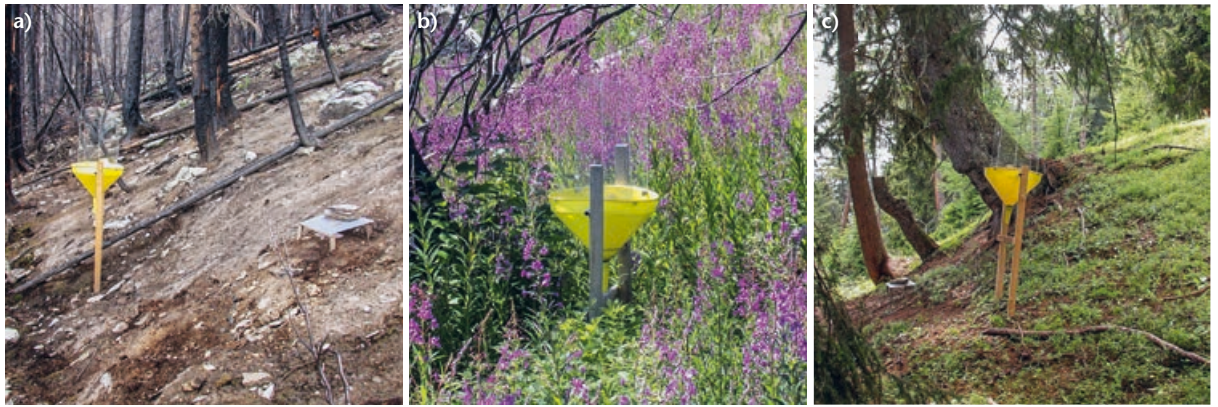
Abb 2 Beispiele von Fallenstandorten a) im Zentrum der Brandfläche 2004, b) im Zentrum der Brandfläche 2006, c) im angrenzenden intakten Wald 2004. Jeder Standort enthält eine gelbe Kombifalle für Fluginsekten und eine Bodenfalle mit Plastikdach für auf der Bodenoberfläche aktive Arten. Fotos: Marco Moretti
