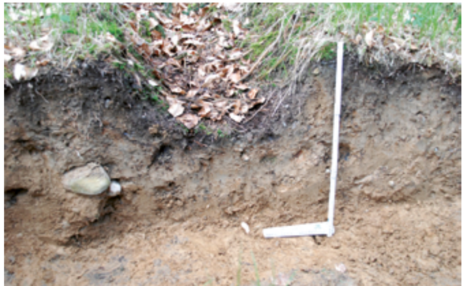
Abb. 2. Fahrspur im Wald, Spurtyp 3. Das Befahren mit Forstmaschinen bewirkt Verdichtungen und Verformungen im Boden.
