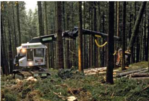
Abb. 2: Fällen und Aufarbeiten mit einem Raupenvollerner am Hang in einem Fichtenbaumholz. Die Maschine befährt dabei die von ihr selbst angelegte Reisigmatte, um den Boden zu schonen und Wurzelverletzungen zu vermeiden.
