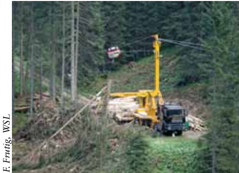
Abb. 7: Mobilseilkran und Prozessor auf gemeinsamem Trägerfahrzeug (Kombiseilgerät) bei der Rückung von Vollbäumen bergauf.
