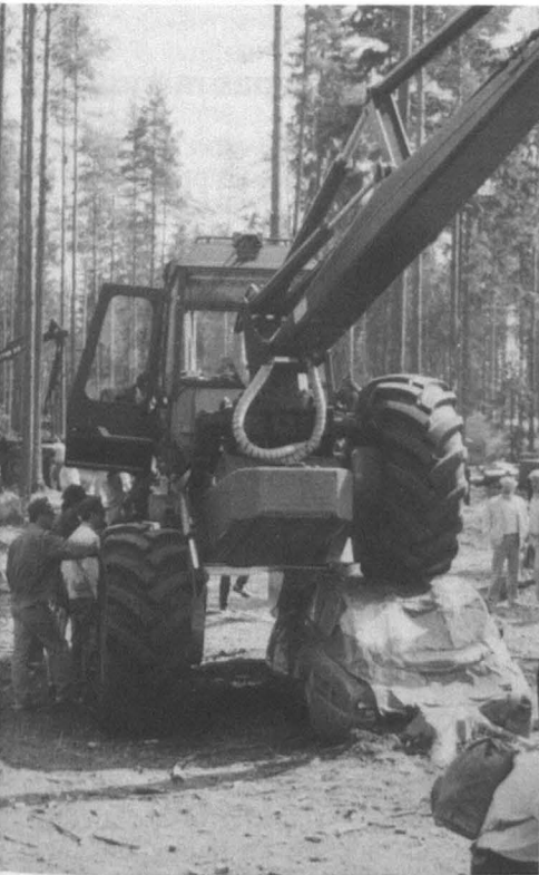
Le châssis hydraulique permet une récolte du bois complètement mécanisée, également sur des terrains irréguliers ou encombrés.
