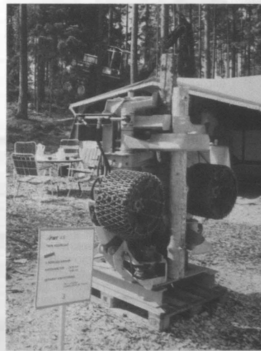
Avec cette nouvelle génération de tête de travail, deux arbres à la fois peuvent être ébranchés et façonnés.
