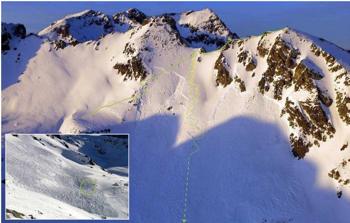
Abbildung 48: Piz d'Agnel (Bivio/GR, 06.01.2015): Blick auf den Ostgrat und die Südflanke des Piz d'Agnel (Gipfel nicht im Foto sichtbar) mit dem 150 m breiten und 70 bis 150 cm mächtigen Lawinenanriss, den Aufstiegsspuren der beiden Tourengerer (grün), den Abfahrtsspuren (grün und gelb gestrichelt) sowie dem Verschüttungsort der ganzverschütteten Person (Kreis im kleinen Bild, Unfall-Nr: 49; Foto: Kantonspolizei GR.).
