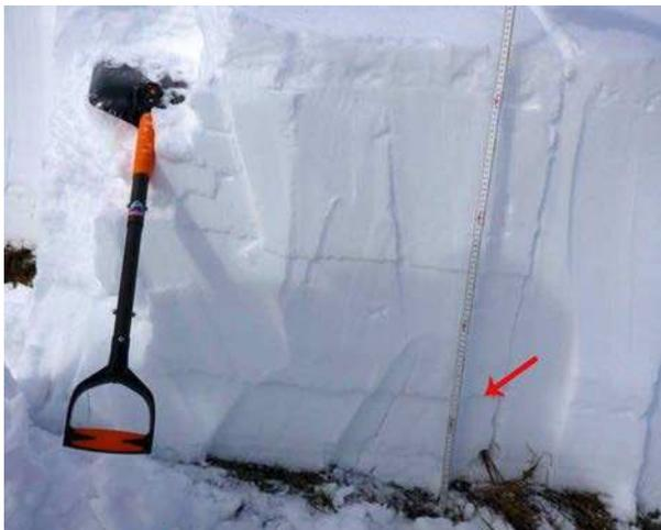
Abbildung 62: Ein Extended Column Test brach, wie der Rutschblockversuch (Abbildung 61), im Neu- und Triebsschnee und am Übergang zur Altschneedecke, der Schwachschicht (roter Pfeil), in welcher die Lawine anbrach (Foto: P. Diener, 31. Januar 2015).
