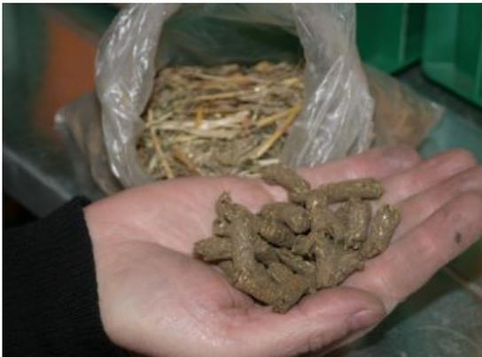
Abbildung 19 Biomassepellets. (Quelle: [bio-burn.ch](http://bio-burn.ch))
