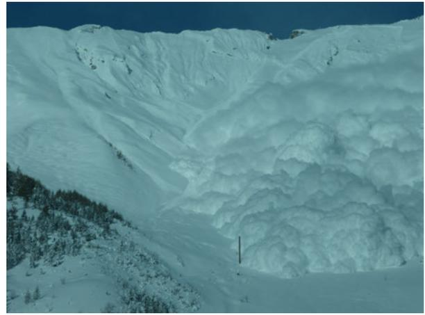
Abbildung 27: Gesprengte Lawine im Testgelände des SLF im Vallée de la Sionne (Arbaz, VS). Der Messmasten (untere Bildmitte) ist 19 Meter hoch (Foto: SLF/automatische Kamera, 18.01.2016).
