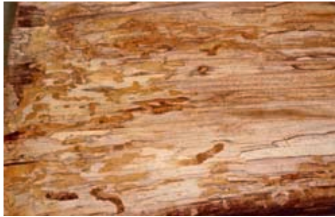
Abb. 11. Die Larvengänge durchziehen das Holz in unregelmässiger Form und sind mit Bohrmehl angefüllt (Bild B. Wermelinger).
