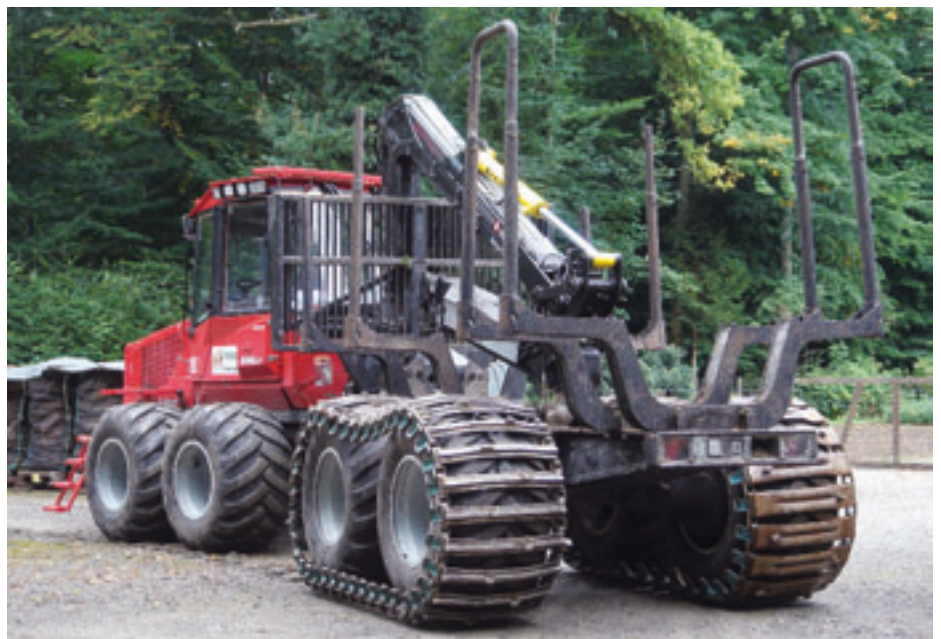
Abb. 13. Der Forwarder wurde zu Demonstrationszwecken mit zwei verschiedenen Arten von Bogiebändern ausgerüstet: links Traktionsbänder zur Verbesserung der Steigfähigkeit und der Sicherheit am Hang, rechts tragende Bänder zur schonenderen Befahrung schlecht tragfähiger Böden in ebenem und leicht geneigtem Gelände.
