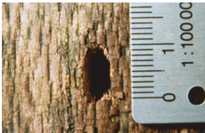
Abb. 13. Das Ausbohrloch misst rund 10 mm in der Länge und liegt parallel zur Faserrichtung des Holzes (Bild P. Duelli).
