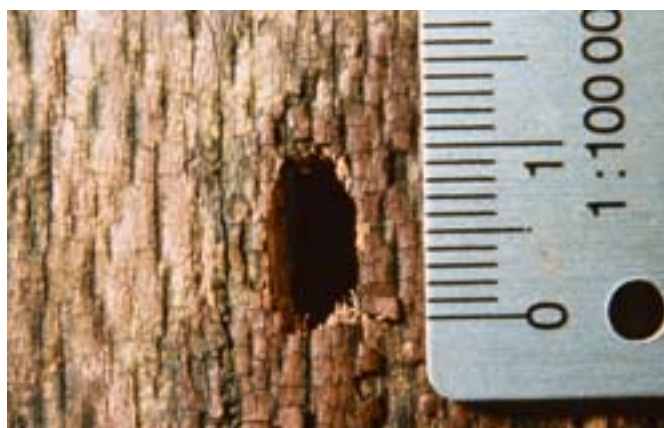
Fig. 13. Le trou de sortie mesure 10 mm de long et il évolue parallèlement aux fibres du bois (photo P. Duelli).
